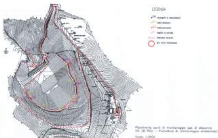
Figura 15-14 Posizioni di misura dei gas interstiziali
