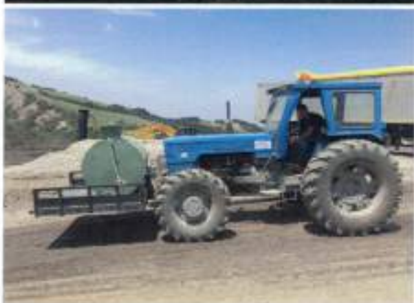
Figura 9-10 - Trattore con botte impiegata per la bagnatura dei rifiuti e delle strade
