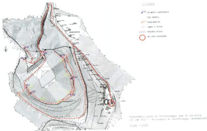
Figura 12-14 Posizioni di misura dei gas interstiziali
